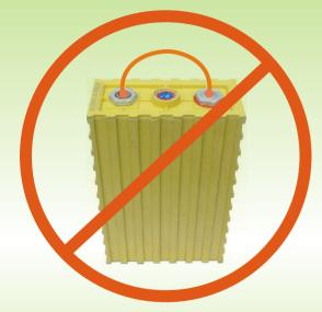
電池短路 Battery short circuit
